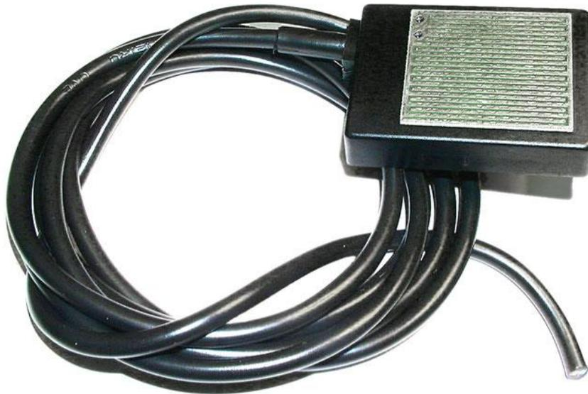
Der Regensensor RES01 wurde für witterungsgeführte Regelaufgaben (z.B. Öffnen und Schließen von Wintergartenfenstern) entwickelt. Der integrierte Messverstärker wandelt das Sensorsignal in einen Temperaturwert um. Die Trockentemperatur beträgt ca. 90°C. Diese kann durch Verschmutzung etwas sinken. Die Feuchteschwelle sollte ca. 20°C unter der angezeigten Trockentemperatur definiert werden.
